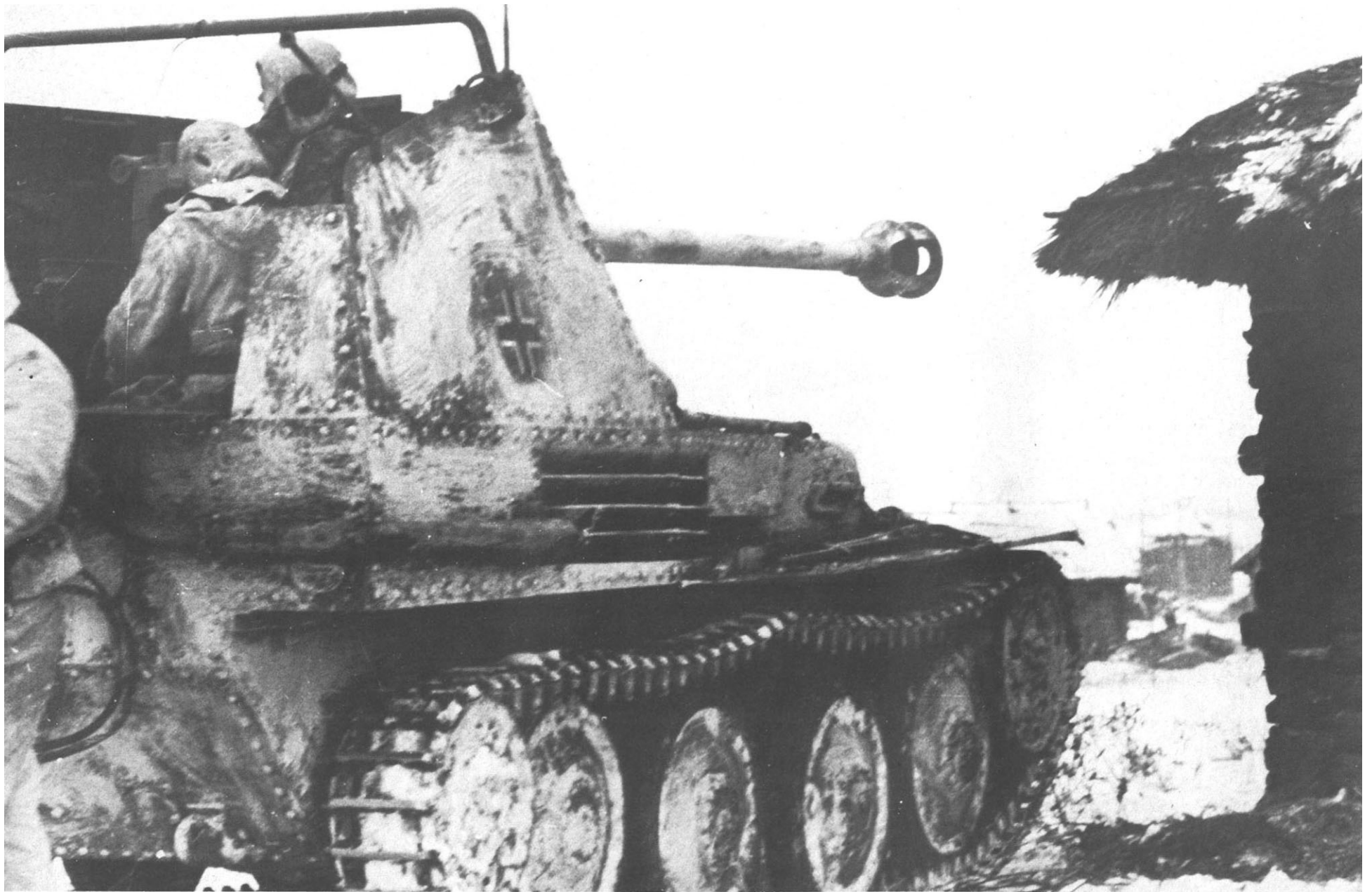
Rußland, Heeresgruppe Mitte, Winter 1943/1944. Der Bügel über dem Kampfraum sowie die an der Seitenpanzerung angebrachten kleinen (hier verbogenen) Stützen dienen zum Halten der Schutzplane (BA).
