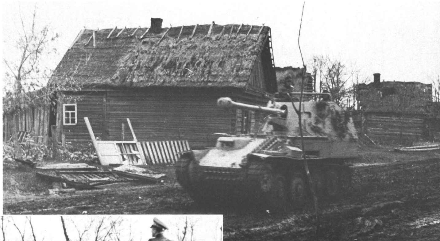
Ein Marder III der Ausführung M mit der 7,5 cm Pak 40/3 (L/46) auf dem Gefechtswagen 38(t) in Rußland, Oktober 1943 (BA).
