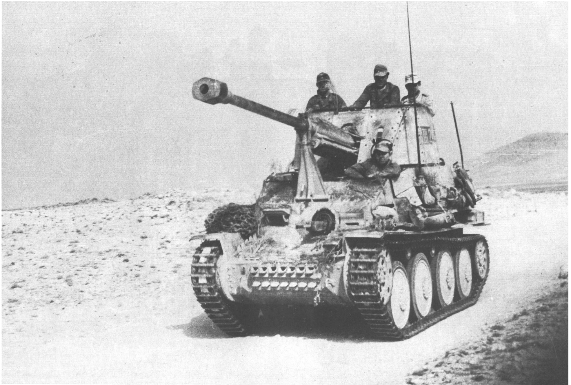
Beim Afrika-Korps waren die Wagennummern zum Teil – wie hier – auf dunklem Grund an den seitlichen Panzerplatten des Kampfraumes zu finden. Auf der rechten Kettenabdeckung liegt ein Tarnnetz (BA).
