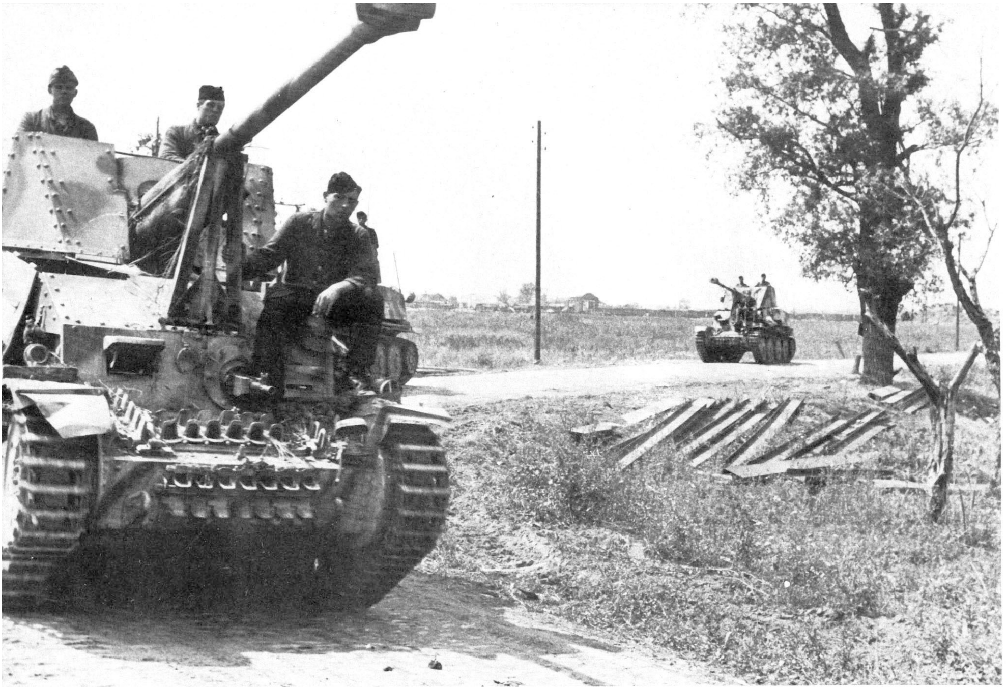
Dieses Foto läßt gut erkennen, daß dieser Panzerjäger höher als breit ist. Hinter der offenen Luke (also rechts!) sitzt der Fahrer. Neben dem hier gut erkennbaren Bug-MG (in Kugelblende) sitzt der Funker — hier außerhalb seines Sitzplatzes (BA).
