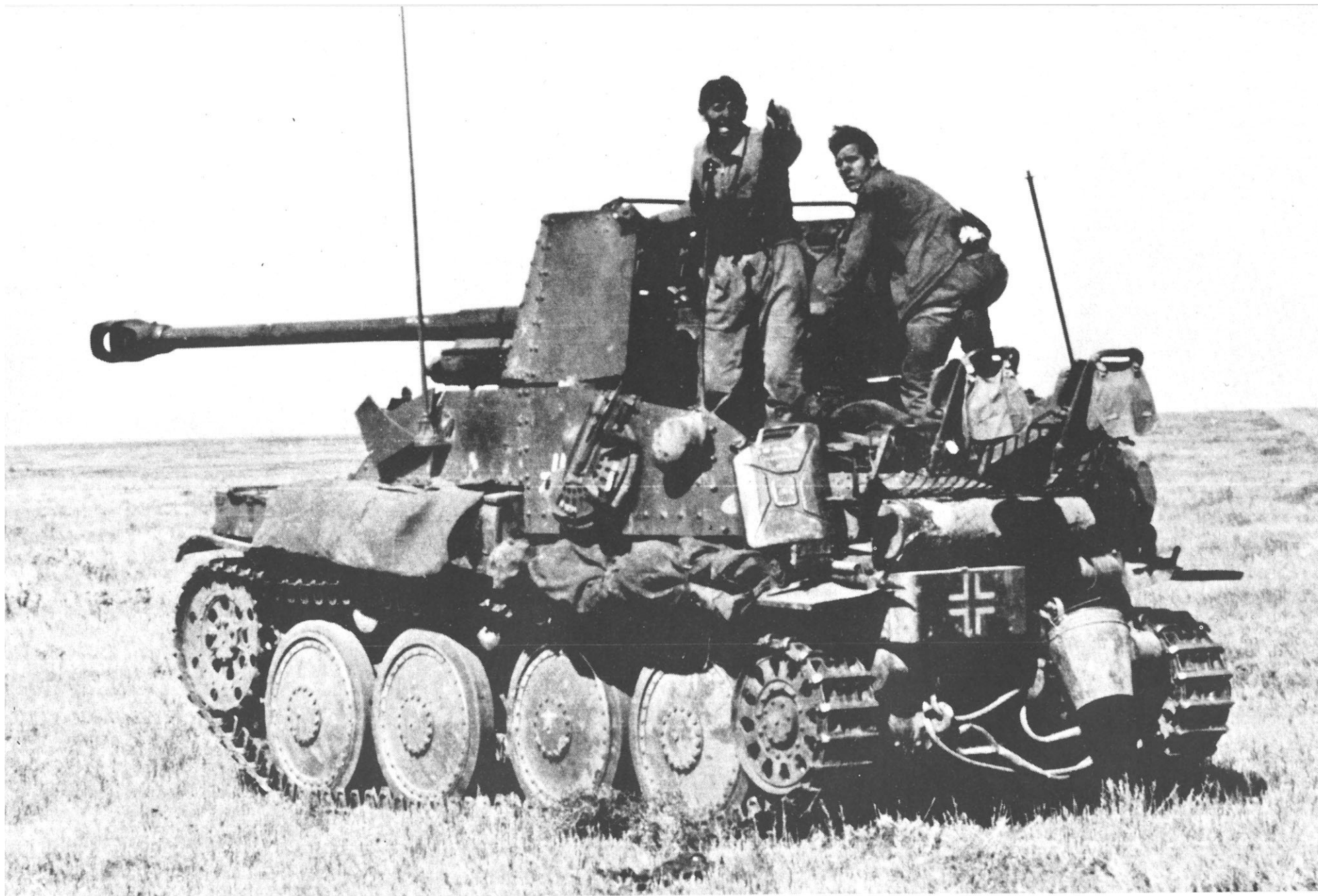
Dieses Foto ist von besonderem Interesse; zeigt es doch was alles am Marder so mitgeschleppt wurde. Neben der Munition (30 Schuß), Stahlhelme, Wasserkannister, Eimer, Abschleppseil, Plane, Decken, Brotbeutel – hier an der Rückenlehne. Dieser Marder stand im Sommer 1942 auf der Steppe Südrußlands (BA).
